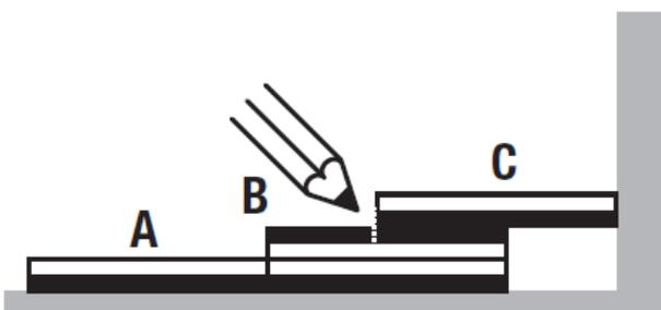
Legen Sie die zugeschnittene Fliese B schließlich zwischen die Wand und Fliese A.
